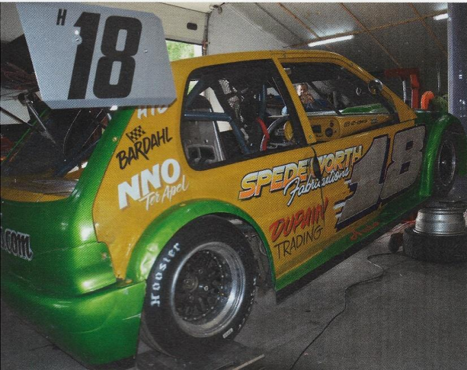
Met één as omhoog en een beetje rekenwerk bepaal je de hoogte van het zwaartepunt.
