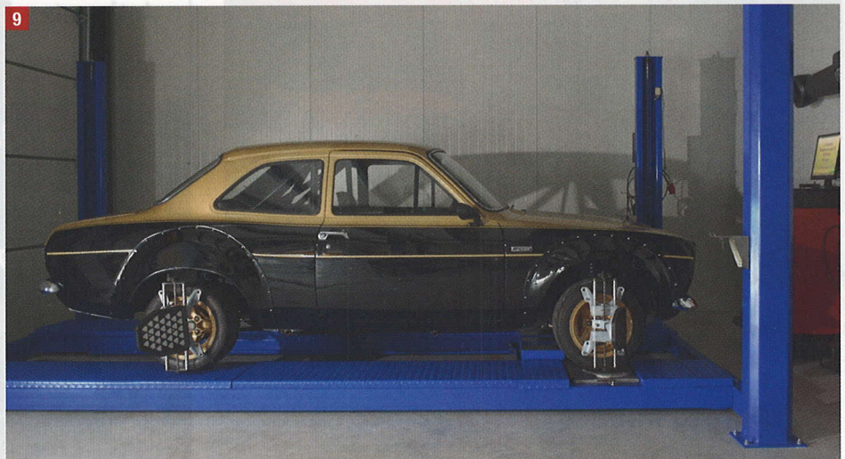
8: Om de diagonalen tussen de wielen linksvoor (LV) en rechtsachter (RA) te kunnen meten maak je een markering op de grond. Gebruik daarvoor bijvoorbeeld een schietlood. 9: JClassics gebruikt de Hunter HawkEye Elite, één van de allerbeste uitlijnbanken.
